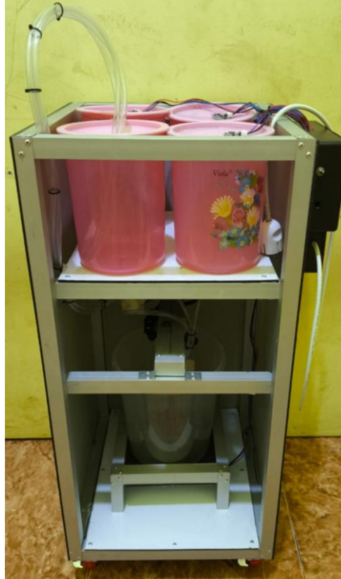
Gambar 1 Hasil rancang bangun alat pencampuran cat air 3 warna dasar (Sumber: Dokumen Pribadi, 2024)
