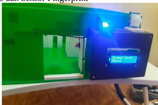
Gambar 2. Tampilan LCD 16x2 dan Scan ID Sidik Jari
